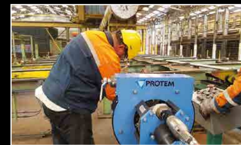
> Верстак с подвижным станком для снятия фасок PROTÉM BMFM для обработки труб с толстыми стенками
