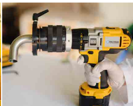
> Станки для торцевания труб позволяют получить безукоризненную поверхность без заусенцев
