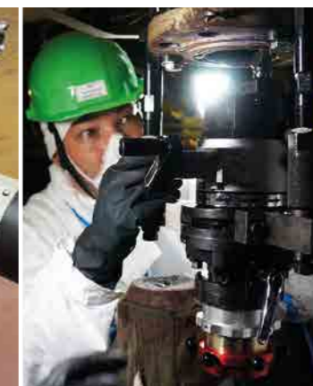
> Обработка на объекте в ограниченном пространстве и под воздействием ионизирующего излучения с помощью станка для торцевания типа SERCO TU
