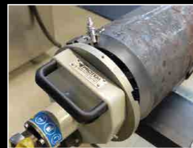
> Станки PROTÉM серии US позволяют осуществлять безупречную подготовку труб к сварке
