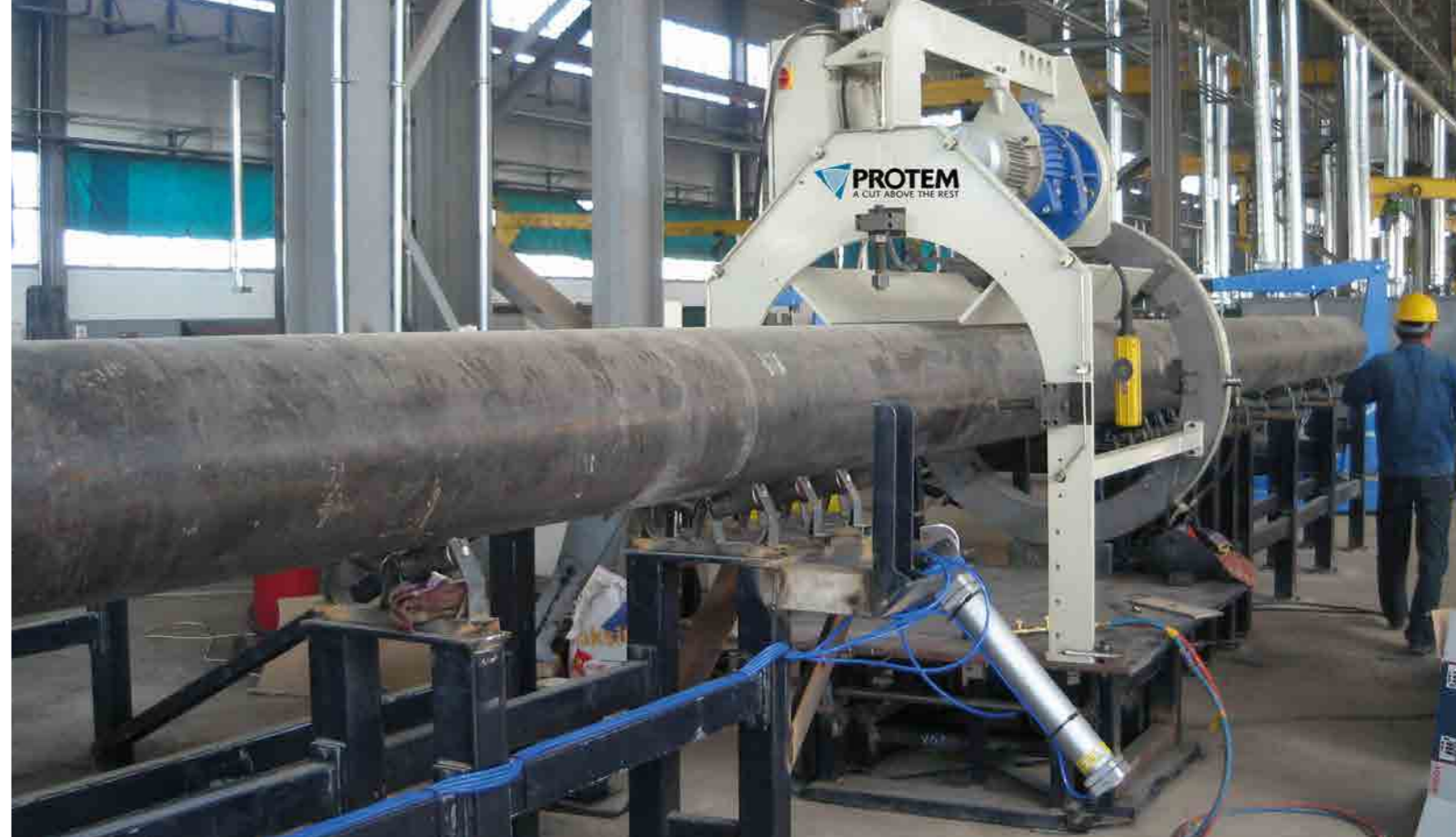
> Предварительная обработка труб на объекте или в цехе с помощью станка для резки и снятия фасок PROTÉM серии TNO
