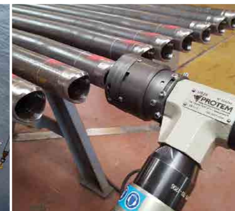
> Станок PROTEM US25GL для выполнения обработки труб перед сваркой встык
