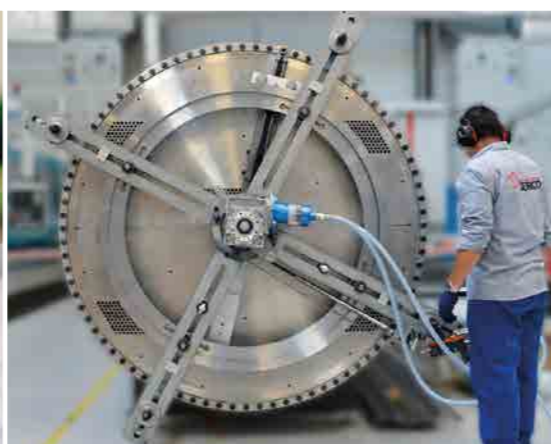
> Портативный обрабатывающий станок для обслуживания и ремонта фланцев и клапанов
