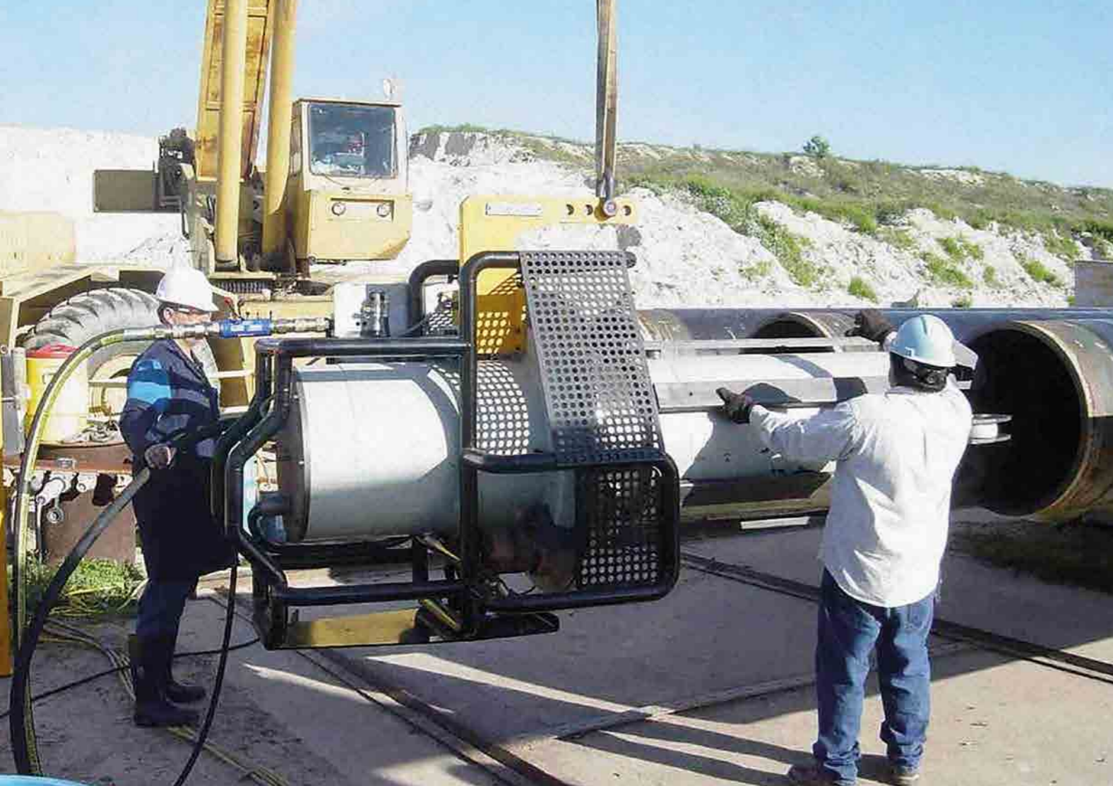
> Обслуживание нефтебуровой платформы с помощью станка для резки PROTEM серии TT
