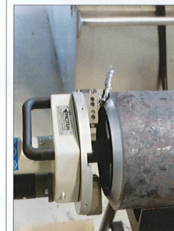
Chanfreineuse PROTEM US25 Chanfrein 30° avec talon constant (débardage intérieur).
