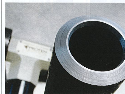
Chanfreineuse PROTEM US25 Chanfrein 30° avec talon constant (débardage intérieur).
