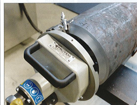
US40, usinage sans lubrification d'un chanfrein composé (tube diamètre 219 mm, épaisseur 25 mm).
