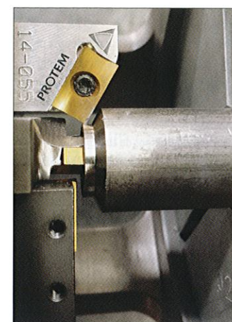
Chanfreineuse portable PROTEM SE90NG. Usinage d'un chanfrein tulipe sur de l'acier superduplex en une seule passe avec préhension extérieure en aluminium.
