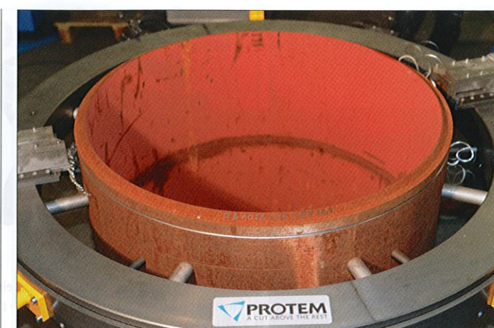
Coupe tube orbital TTNG-1200. Coupe et chanfrein de l'extrémité d'un tube Ø 1 026 mm sans zone affectée thermiquement et sans lubrification.
